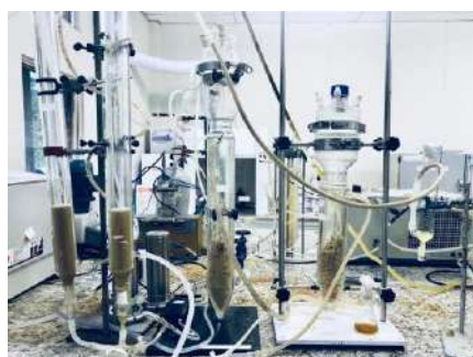
Figura 2 – Produção de biomoléculas a partir de subprodutos agroindustriais em biorreator de coluna de bolhas no Laboratório de Bioprocessos e Produtos Sustentáveis (Fonte: Autoria própria).
